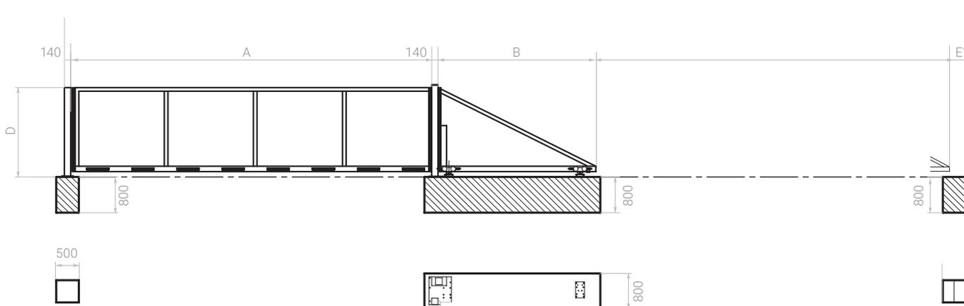
\*E = 500 mm (sans palpeur de sécurité arrière) ; E = 150 mm (avec palpeur de sécurité arrière)
